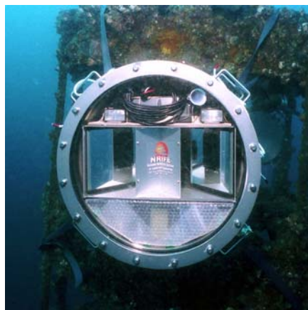
人工魚礁に設置した フィスコム試作機
