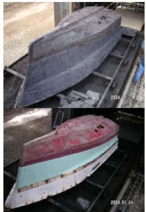
図2 FRP漁船の炭化処理 (下図：炭化前、上図：炭化後)
