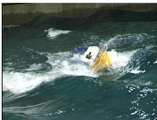
図1 追波中まき網漁船の転覆模型実験 (ブローチングによる転覆)
