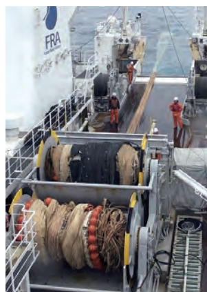
写真1 2段式トロールウィンチ 表層(手前)、中層(奥)の2網を 巻き込んでいる
