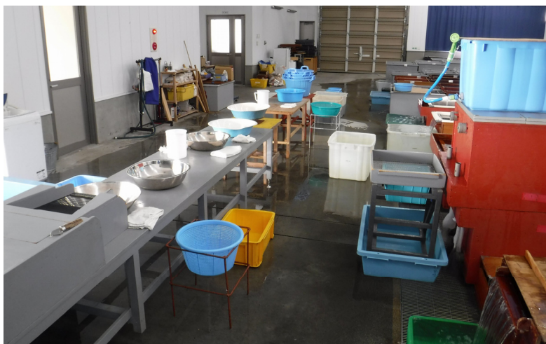
洗卵工程全体図（採卵から吸水前消毒までの動線を直線状に配置）
