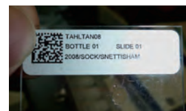
写真4 耳石のプレパラート標本にはデータベース用のQRコードが貼り付けられている。
