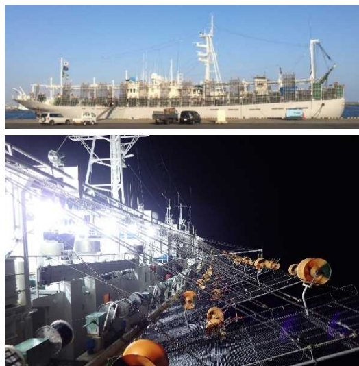
図2. 調査で用船した大型いか釣漁船「第三十開洋丸(349トン)」(上)と、自動いか釣機による調査風景(下)
