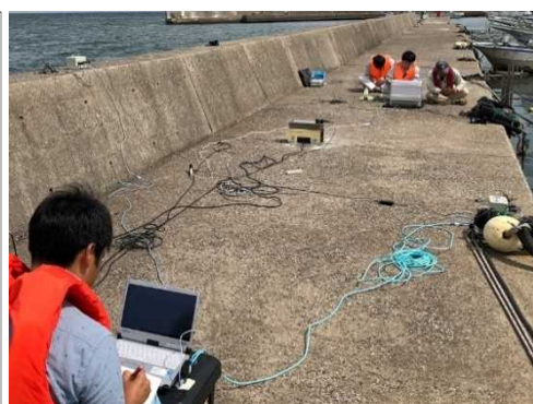
図 2. ロッキング振動のメカニズムと鉛直変位量差による基礎部の変状の検出イメージ(左)と、試験風景(右)
