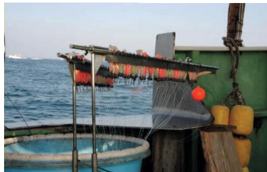
図2. 投縄装置（操業準備が完了）
