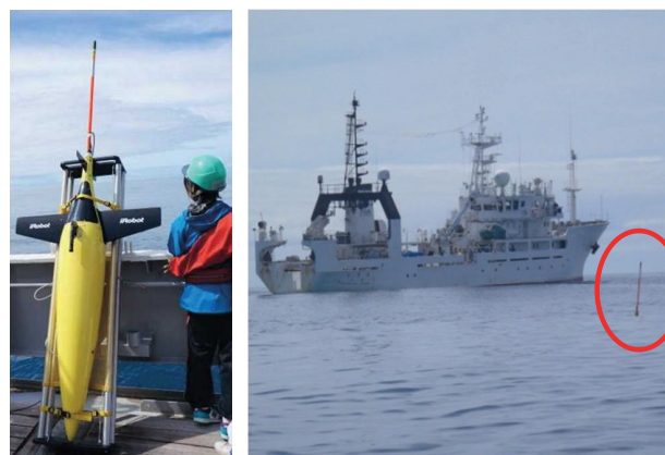
図 2. 右: 今回導入した水中グライダー、左: 若鷹丸の右側でアンテナを立てている水中グライダー（赤丸）
