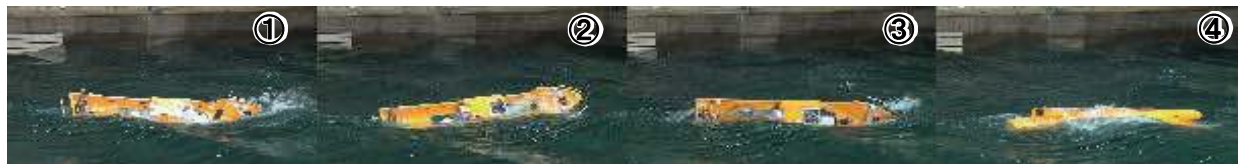
写真1. 大波高、向波中を航行する様子（安全性向上改造前・転覆してしまう）
