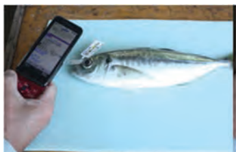
図2. 装着したタグより携帯電話による情報の読み取り
