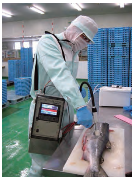
図1. 開発したハンディー型身色計測装置の現場評価試験
