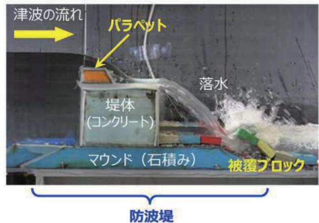
図 2. 津波を再現した模型実験
