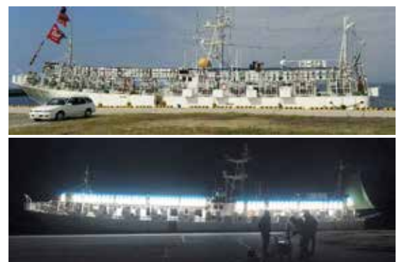
図2. LED 漁灯を装備して実証試験を行ったイカ釣り漁船
