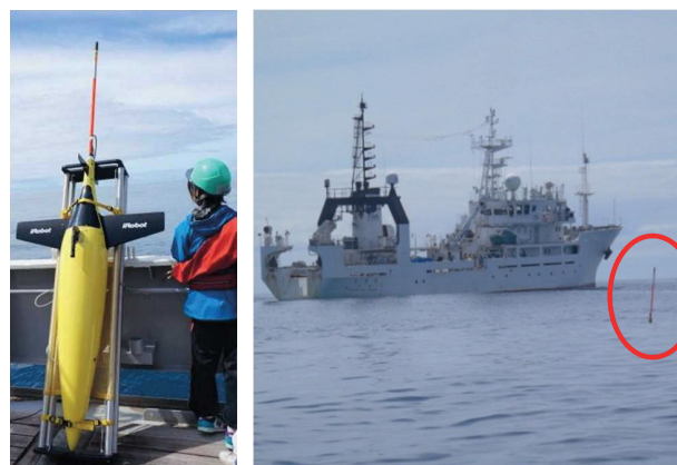
図 2. 右: 今回導入した水中グライダー、左: 若鷹丸の右側でアンテナを立てている水中グライダー（赤丸）
