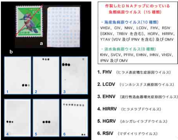
図4 作製した魚類病原ウイルス検出用DNAチップ aは作製したチップ（わかりやすくするためDNAのスポットを青く染色）、bは検出した事例、強く黒色を示すスポットが陽性で、検出には横並びの3スポットが陽性であることが必要。
