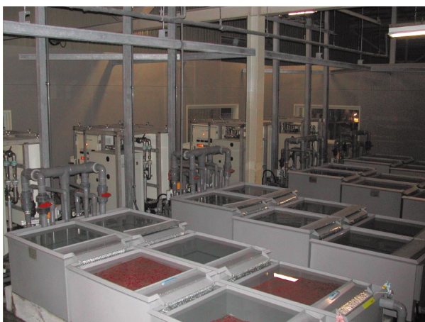
写真3 さけますセンター千歳事業所に設置された耳石温度標識装置
