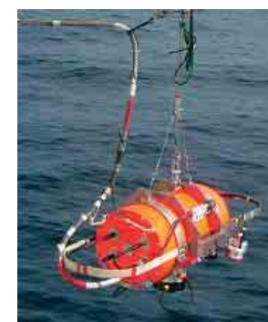
図7 海上実験中のJ-QUEST \chi 下側に突出しているのが500m耐圧型送受波器。
