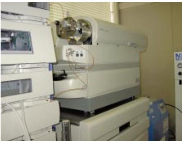
写真3 液体クロマトグラフィー/質量分析装置
