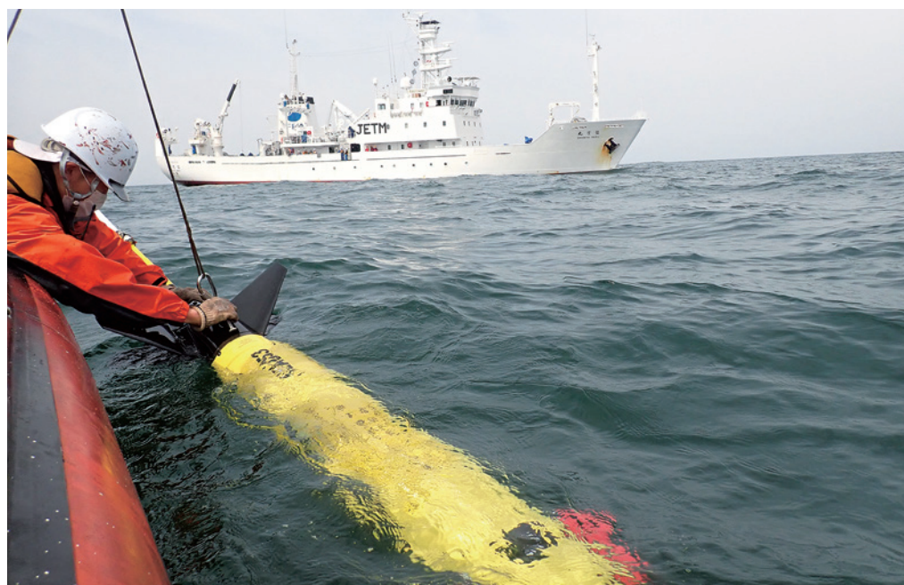
写真 長期運用した水中グライダーを回収 母船の漁業調査船俊鷹丸（887トン）からボートを降ろし、水中グライダー（全長約2メートル、重さ約60キロ）を回収するようす
