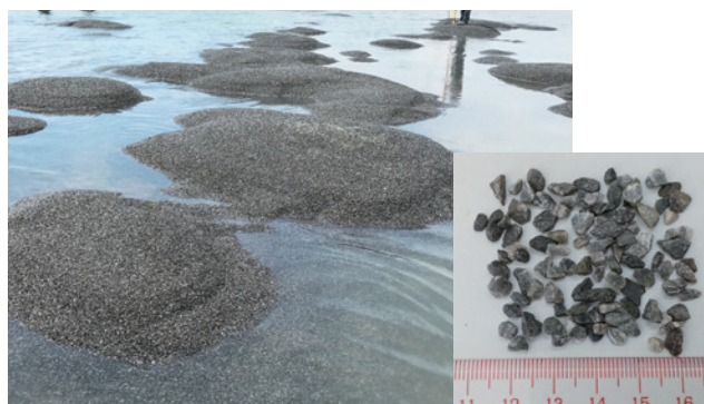
写真1 愛知県三河湾衣崎地区に敷設された碎石（左） （粒径2.5～5.0ミリ程度）とその拡大画像（右）
