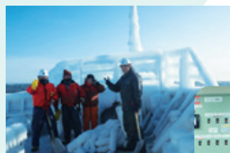
船走中の波しぶきや雨雪によって船体着氷が起きることがあり、乗組員で力を合わせて船上の氷を落としています。
