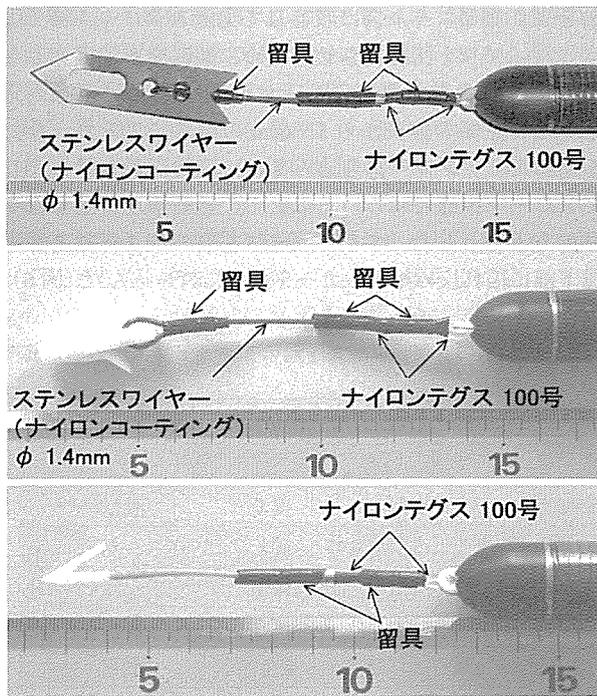
図4. アンカー、曳航索（ステンレスワイヤーおよびナイロンテグス）、PATの連結の仕様
