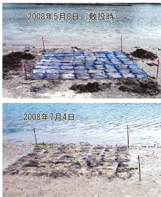
写真2. 2008年5月8日の「ケアシェル」敷設時および7月4日の敷設区の状況
