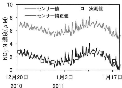
図7. 2010年12月20日から2011年1月20日までのセンサー値、センサー補正值および同期間中の実測値
