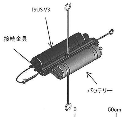
図2. 本研究で設置した硝酸塩センサー ISUS V3
