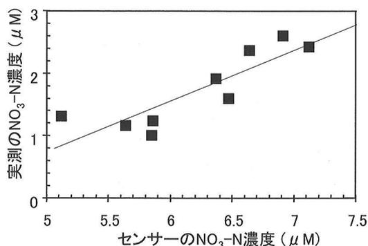
図6. 硝酸塩センサーを用いたNO<sub>3</sub>-N濃度とオートアナライザーによるNO<sub>3</sub>-N濃度実測値の関係
