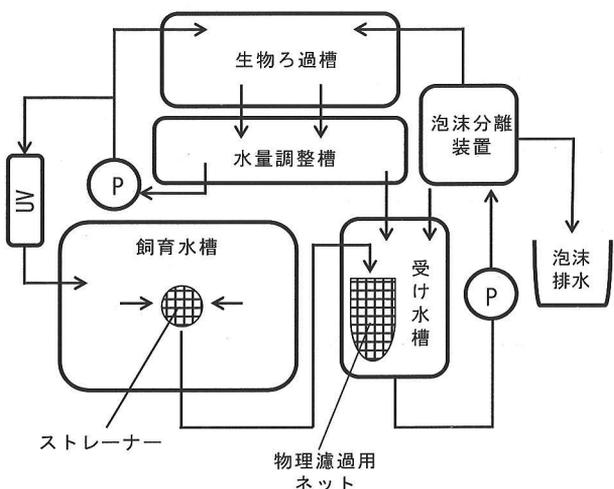
図1. 閉鎖循環システムの模式図
