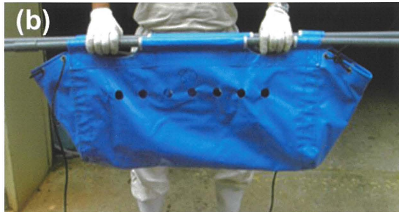
写真1. (a) キャンバスシート製バケツ (直径80cm, 深さ80cm, 容量400L), (b) ターポリンシート製担架 (長さ80cm, 深さ35cm)
