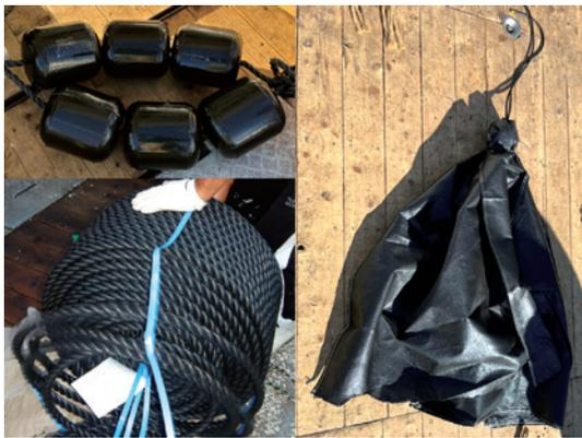
写真 ポリ乳酸(PLA)製のFADs素材
