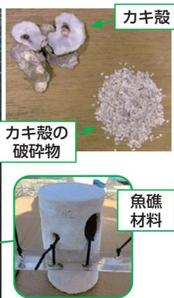
カキ殻は粉砕しやすく、炭酸カルシウムが主体の粉末を安価に製造できます。現在、私たちの研究室では、粘土にカキ殻粉末を加え焼き固めたブロックなどの高圧縮強度材料を、土木建築分野で活用できないか検討しています。この材料は多孔質であり、有用なミネラル分や養分を含ませることも可能なことから、魚礁材料としての発展も期待できます。
