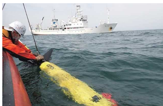
写真 長期運用した水中グライダーを回収 母船の漁業調査船からポートを降ろし、 水中グライダー（全長約2メートル、 重さ約60キロ）を回収するようす
