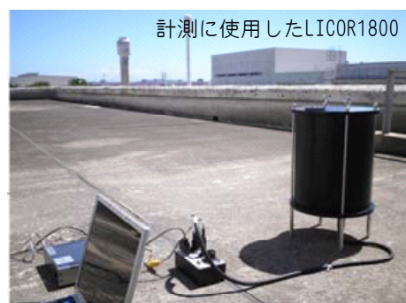
太陽光パネルの分光発電量の計測
