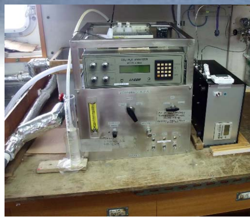
蒼鷹丸と搭載された pCO_2 自動モニタリングシステム
