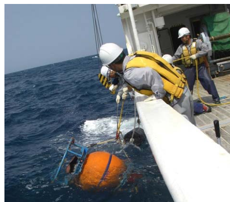
モニタリングのための超音波流速計の回収
