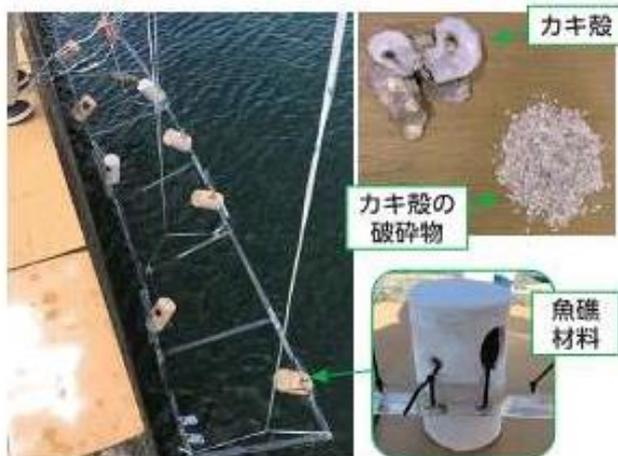
海中への焼成試験体の設置作業のようす
