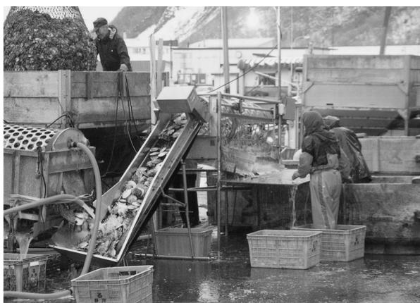
Fig. 12. ホタテガイ (成貝) の選別・洗浄作業
