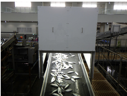
図1. 松浦魚市場のベルトコンベア上に設置した撮像装置
