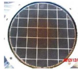
図7. 再生後のフィルタエレメント表面の写真
