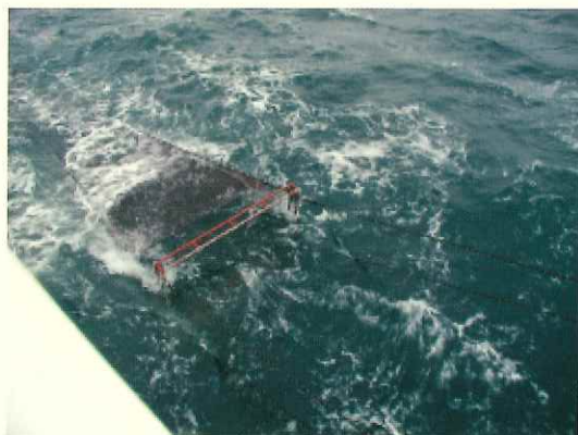
フレームネットとその曳網状況
