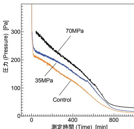
図 1) エビのフリーズドライ処理中の圧力変化
