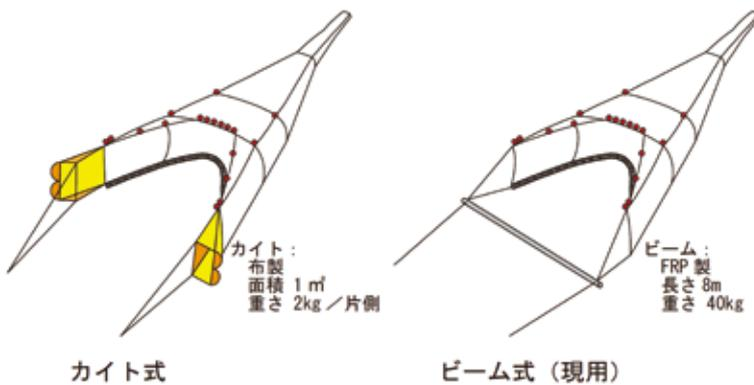
図1) 実証試験に使用した小型底びき網漁具の概要
