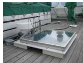
図 2) 熱電併給型ソーラーパネル実験装置 Experimental apparatus of the onboard solar cogeneration system.
