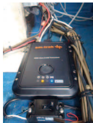
船舶自動識別装置（簡易型） AIS (ClassB)
