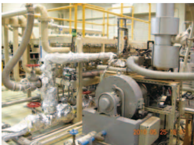
図1) 実験用エンジンと NO x 低減システム Test engine and NO x reduction system
