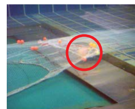
図2) 網内に入った模型クラゲが排除される様子 ～大型クラゲを排除する技術～
