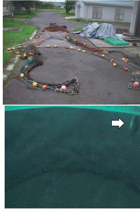
上：試験漁具 (白い網地が目合拡大部分) 下：水中映像の例 (カスゴ)
