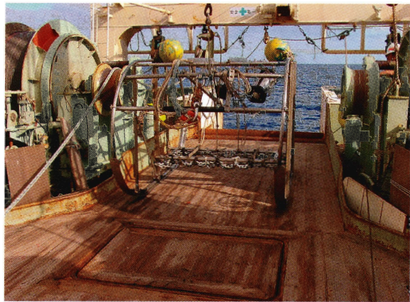
図 1 改良した曳航式深海用ビデオカメラ
