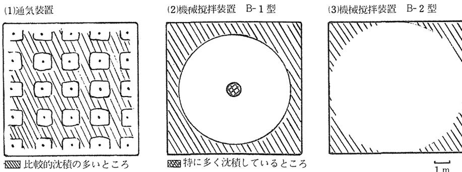
機械的攪拌装置を用いたB-1およびB-2型の場合の沈澱物沈積状態は概略、それぞれ図7-2および7-3のようになる。B-1型では、回転シャフトの周辺、とくに半径70~100cmの範囲により多くの沈積が観察された。B-2型では、水槽の4角みに多く、中央部における上記の沈積は殆んど認められなかった。これは内側の通気が有効に働いたためと考えられる。
