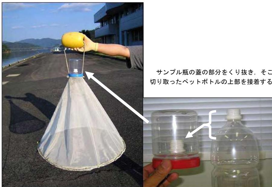
サンプル瓶の蓋の部分をくり抜き、そこへ切り取ったペットボトルの上部を接着する。
