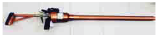
図3 LK-ARTS 空気の出し入れを行なうレバーとダットサイトを装備している。
