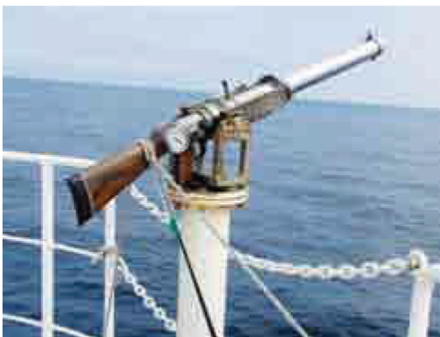
図1 国際水研でのツチクジラへのデータロガー装着に使用した空気銃手持ちで撃つことはできず、銃座が必要である。
