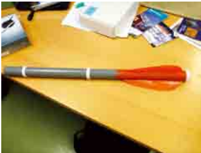
図4 衛星標識用のキャリア 塩化ビニルのパイプでできており前方に円筒状のアルゴスPTTをセットする。
