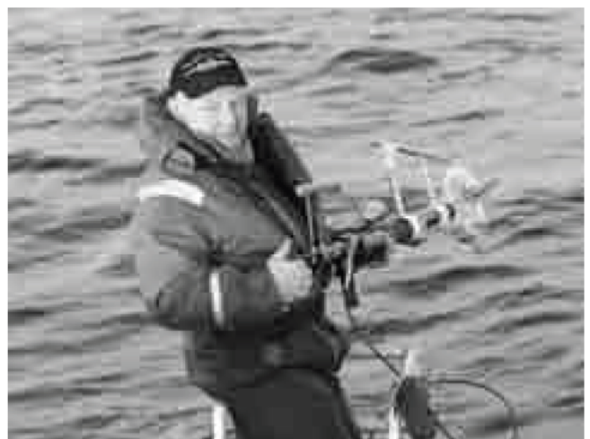
図13 プラストール号船首プラットフォームでLK-ARTSを構えるクレイバン氏 このLK-ARTSにはオプションの圧力計と照準、肩当てが装着されている。ホースは船首に固定した小型エアボンベに接続されている(この写真だけモノクロ)。
