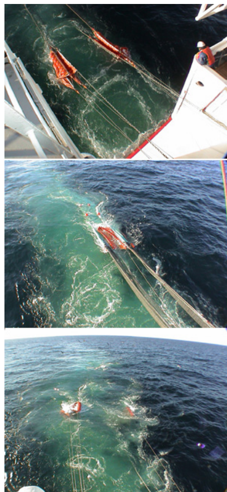
図6. LCネット投網(上:スリップウエー通過、中:カイト展開前、下:カイト展開開始)。カイトが完全に展開して網口が開いた状態のものは表紙の写真)
