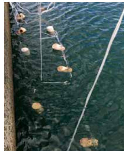
図2 海中に設置される焼成試料
