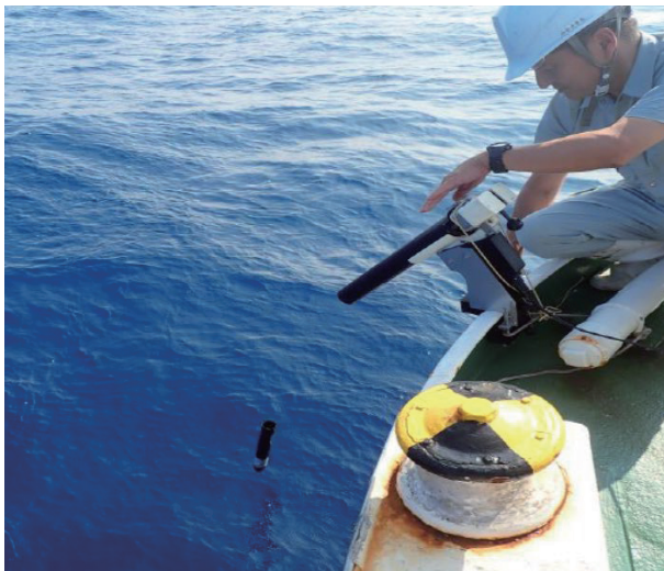
写真2. みやざき丸右舷後尾にクリップで固定されたランチャーから投下されるXCTDプローブ (2018年8月)
